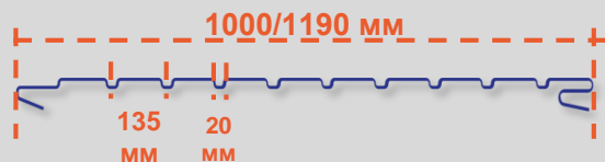
9-rib трапеция Шаг 135 мм.
